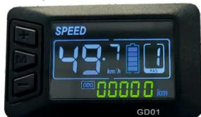
**Управляющий велокомпьютер** Gelbert Gd01 с LCD-дисплеем является универсальным много-функциональным устройством для управления велогибридом с возможностью широкой настройки показателей, управляющих функций и многих параметров. Подробнее о функциях и настройке велокомпьютера читайте в следующем разделе.
