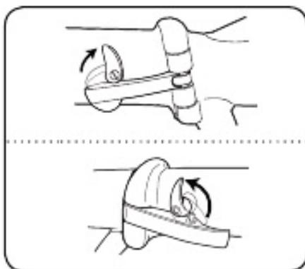
Разложите раму и рулевую колонку, переведя рычаги быстрой фиксации (эксцентрики) в положение «закрыто». Каких-либо специальных инструментов не требуется.
